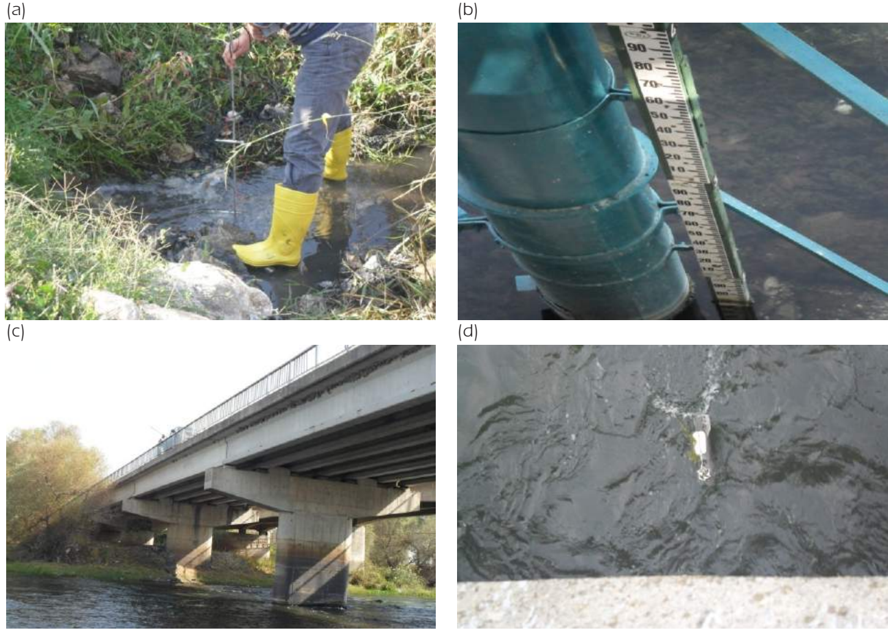
Şekil 3. (a) Akçalar Deresi Debi Ölçümü, (b) Göl Su Kotu, (c) Kocasu Çayı'nda Debi Ölçümü (Uluabat Köprüsü Üzerinden), (d) Köprüden Sarkıtılan Muline
